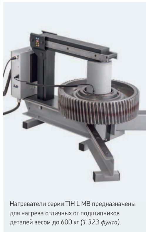
Нагреватели серии TIH L MB предназначены для нагрева отличных от подшипников деталей весом до 600 кг (1 323 фунта).
