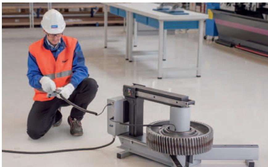
В целях безопасности индукционный нагреватель серии TIH L MB оснащается панелью дистанционного управления.
