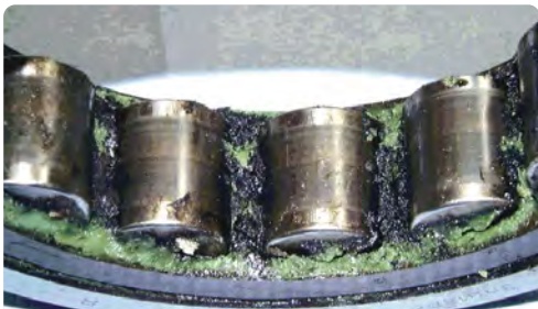
Деградация смазки по причине токов электрического разряда
