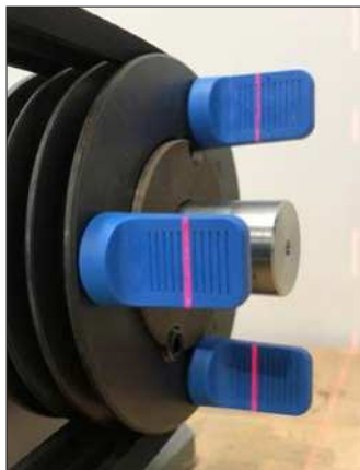
Fig.10 – Correção de desalinhamento angular horizontal
