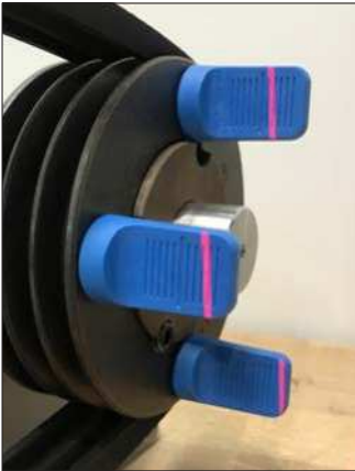
Bild 8: Darstellung einer Kombination aus allen drei Fehlausrichtungen
