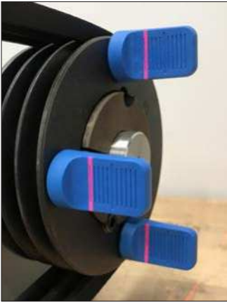
Bild 7: Darstellung einer Parallelschiefstellung (Versatz)
