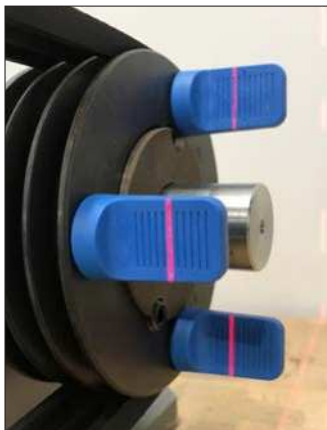
Bild 10: Horizontaler Winkelversatz und Ausrichtung nach der Korrektur
