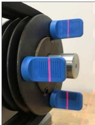
Fig. 10 – Correzione disallineamento angolare orizzontale
