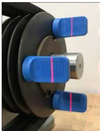
Fig.6 – Exibição de desalinhamento angular horizontal
