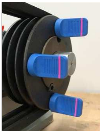
Fig. 11 – Disallineamento parallelo prima e dopo la correzione
