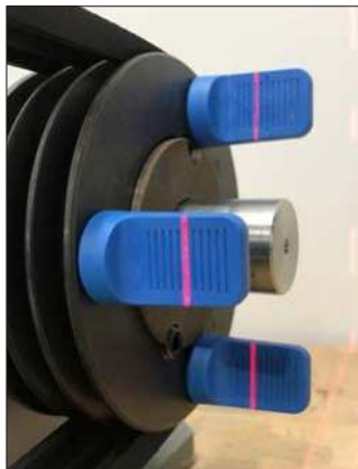
图 10 - 水平角度不对中的纠正
