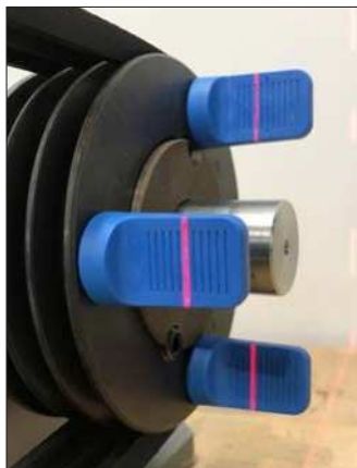
Fig. 10: Corrección de la desalineación angular horizontal
