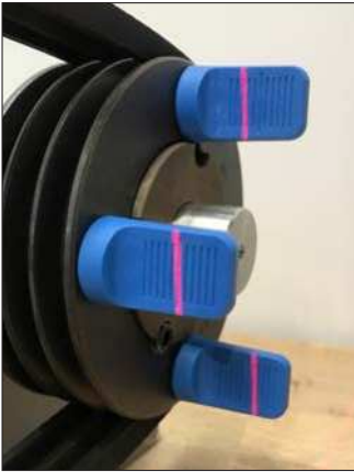
Bild 5: Darstellung eines vertikalen Winkelversatzes
