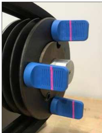
Fig. 9: Corrección de la desalineación angular vertical
