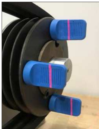
Fig.9 – Correção de desalinhamento angular vertical
