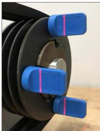
Fig.7 – Exibição de desalinhamento paralelo (deslocamento)
