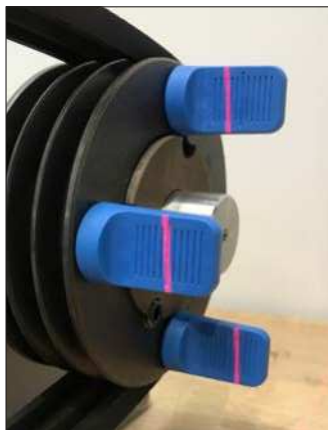
Рис. 9 – Исправление вертикального углового перекося
