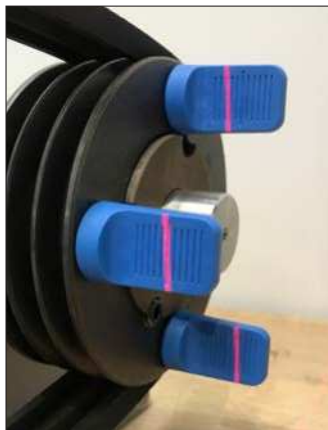
Fig. 9 – Correzione disallineamento angolare verticale
