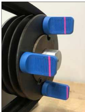
Fig. 8 – Esempio di tutti e tre i disallineamenti combinati
