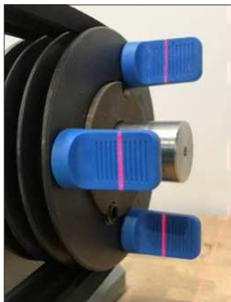
Рис. 6 – Отображение горизонтального углового перекоса
