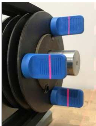
图 6 - 水平角度不对中的显示情况
