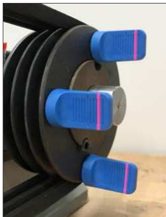
Fig. 11: Desalineación paralela detectada y después de la corrección
