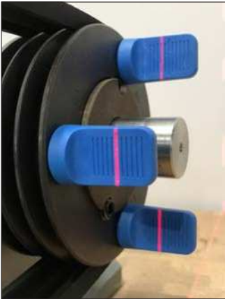
Bild 6: Darstellung eines horizontalen Winkelversatzes
