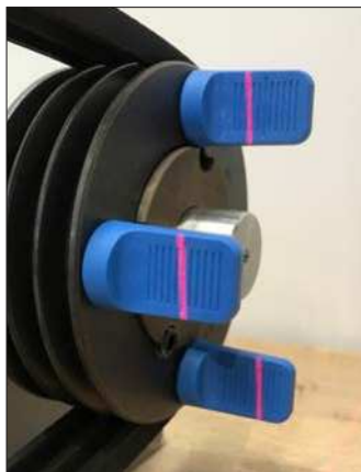
Fig. 5 – Esempio disallineamento angolare verticale
