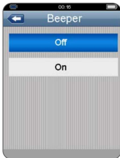
Нажмите кнопки UP и DOWN для выбора режима работы звукового сигнала, нажмите кнопку ESC для выхода и сохранения выбранного режима.
