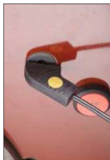
Рис. 15 Поместите магнитную термопару на металлическую поверхность, например, на болт устройства EAZ
