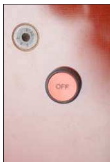
Рис. 18 Кнопка аварийного останова на передней стороне катушки
